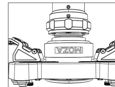
1. Faites correspondre la position des 6 billes en acier sur la tête femelle à verrouillage rapide du volant aux 6 rainures sur la tête mâle de la base.
