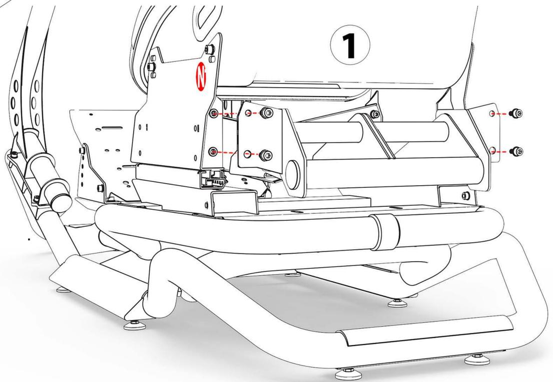
**1** Installer le support de buttkicker sur le Châssis N1 avec 4 vis M8 x 20mm (2 par glissière) à l'aide de la clé Allen 6mm fournie avec l'ensemble
