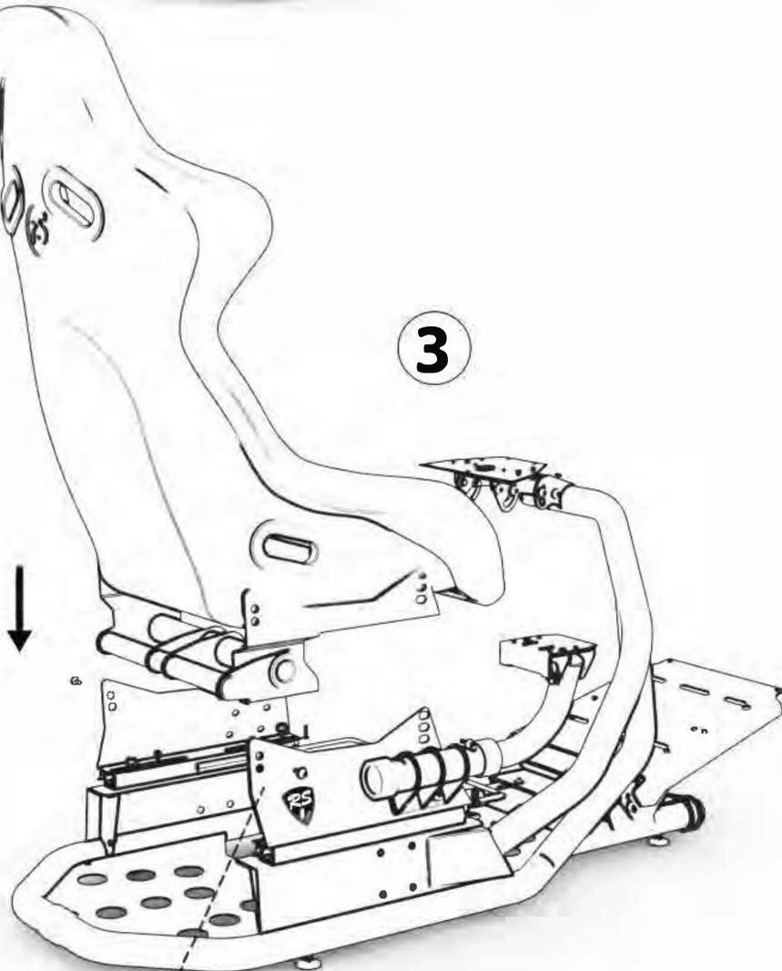
Remettre le siège sur le châssis avec le support installé et visser très soigneusement sur le châssis. Vous pouvez ajuster l'angle du siège à votre guise avec le support ButtKicker installé.
