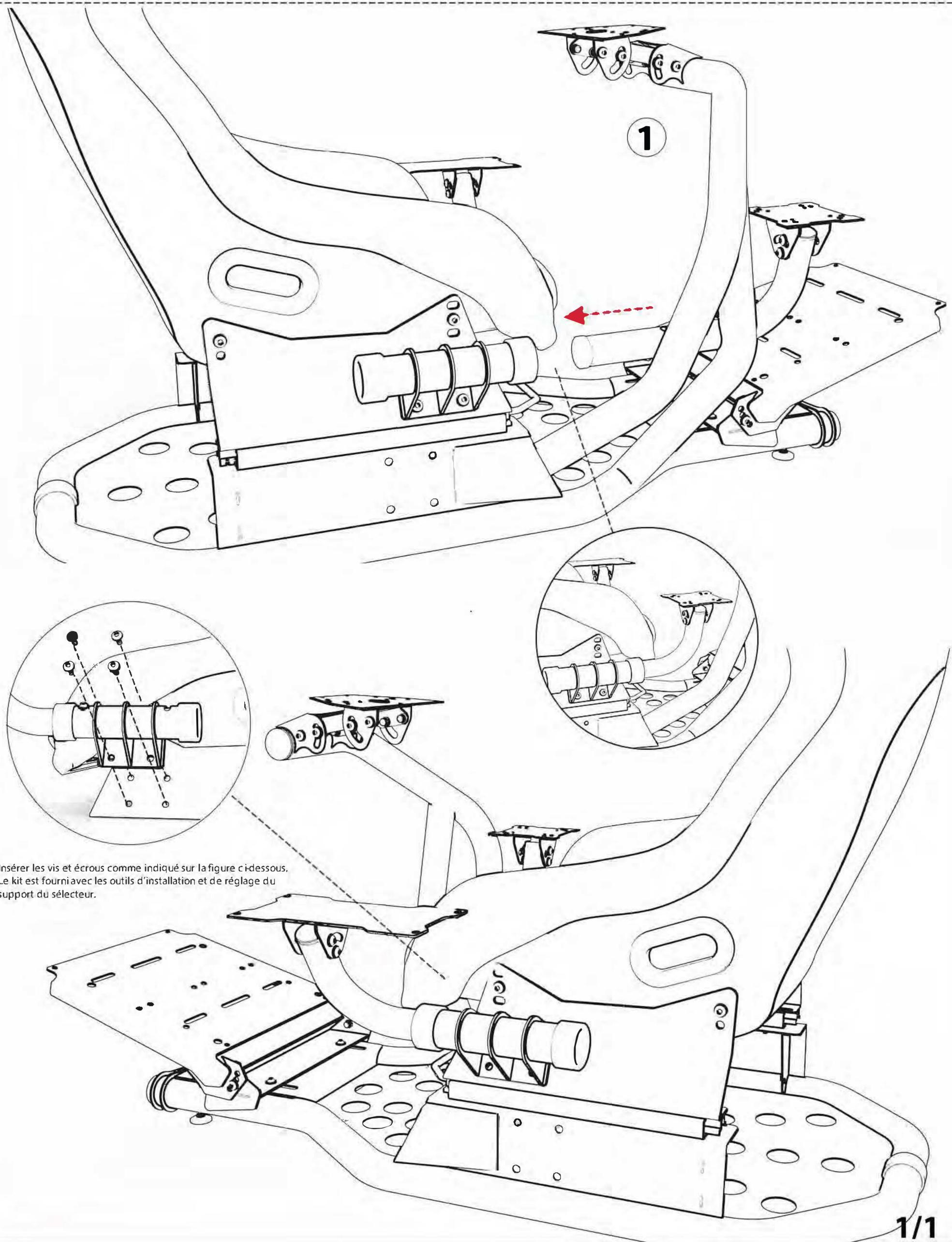
Insérer les vis et écrous comme indiqué sur la figure ci-dessous.
